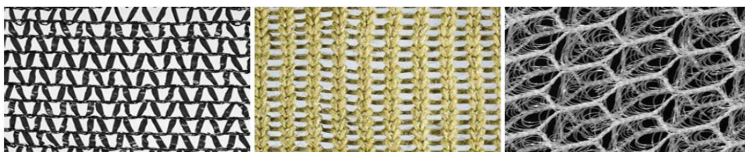
الشكل (3): أنواع النسيج المستخدمة في شبكات حصاد مياه الضباب.
